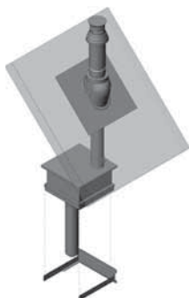
System PowerVent® 2.0 dla przepustów dachowych Montaż jednostki wentylatora pod dachem za pomocą różnych akcesoriów (obejma montażowa, aluminiowy przepust dachowy, zestaw przepustu dachowego)
